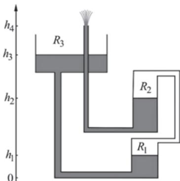
с открытым резервуаром  $R_3$ , заполненным водой, и резервуаром  $R_2$ . От резервуара  $R_2$  отходит тонкая трубка, из которой бьет струя фонтана с уровня  $h_4=1,55$  м. Уровни воды в резервуарах соответственно равны  $h_1=0,25$  м,  $h_2=0,95$  м,  $h_3=1,35$  м. Найти скорость воды на уровне  $h_4$  и длину струи.
