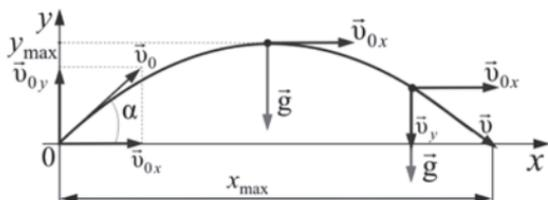
Движение данного тела можно представить как результат наложения двух одновременных прямолинейных движений по осям  $Ox$  и  $Oy$ , направленных вдоль поверхности Земли и по нормали к ней.
