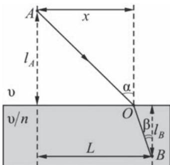
Пункт  $A$  находится на асфальтированной площадке, пункт  $B$  — на примыкающем к нему земляном поле, на котором скорость машины в  $n$  раз меньше. Для того чтобы за кратчайшее время добраться из  $A$  в  $B$ , был выбран оптимальный маршрут, показанный на рисунке. Найти соотношение между синусами углов  $\alpha$  и  $\beta$ .
