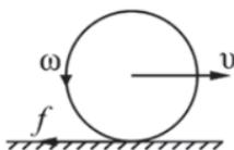
**Задача 1.7.12\*.** Цирковой артист бросает на арену обруч массой  $m$  и радиусом  $R$ , который катится в горизонтальном направлении со скоростью  $v$ . При этом обручу придано обратное вращение с угловой скоростью  $\omega$ . При какой угловой скорости обруч после остановки покатится назад к артисту? Найти конечную скорость  $v_f$  поступательного движения обруча.
